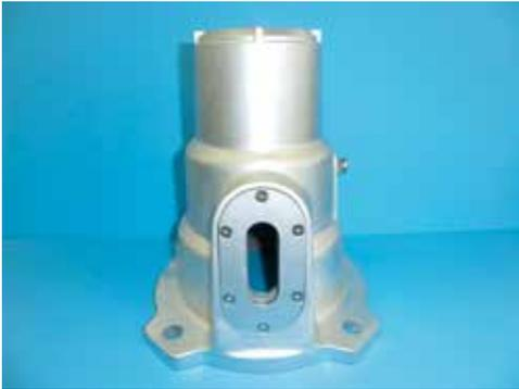
見える化窓により、維持管理段階では、頭部キャップを外さず内部目視が可能になることから、通常、キャップを外して行う頭部露出調査の箇所選定が適正になります。維持管理での防錆油変化および施工時の防錆油充填確認が目視管理できます。これにより、調査の経済性が向上します。
