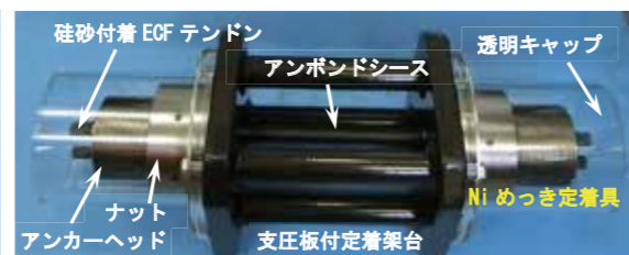
塩害環境促進試験 3600h でアンカー頭部構造の密封耐久性を確認
