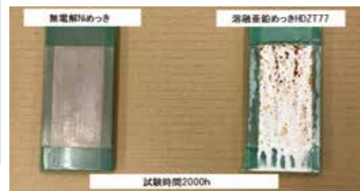
塩害環境促進試験 2000h で無電解 Ni めっきの耐久性を確認
