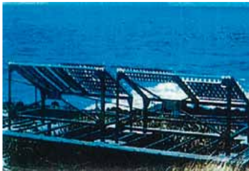
三宅島屋外暴露試験状況 (14 年経過)
