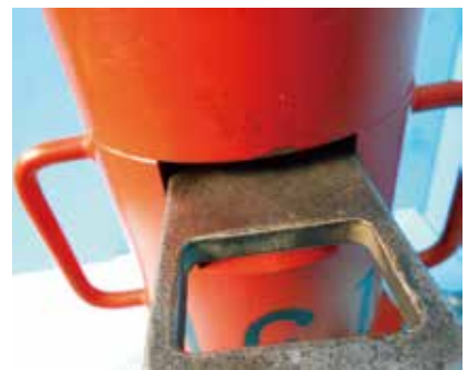
シャッター板をセットした状態
