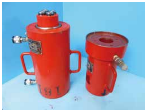
メインジャッキ+定着ジャッキ
