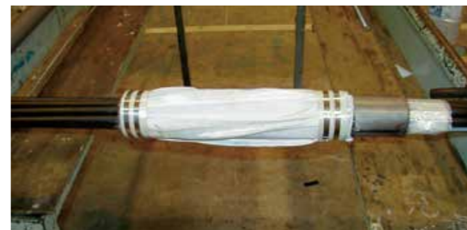
引抜き試験パッカー (ゴムパッカー) 仕様
