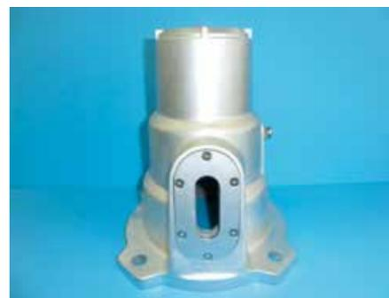
見える化窓により、維持管理段階では、ヘッドキャップを外さず内部目視が可能になることから、通常、キャップを外して行う頭部露出調査の箇所選定が適正になります。維持管理での防錆油変化および施工時の防錆油充填確認が目視管理できます。これにより、調査の経済性が向上します。
